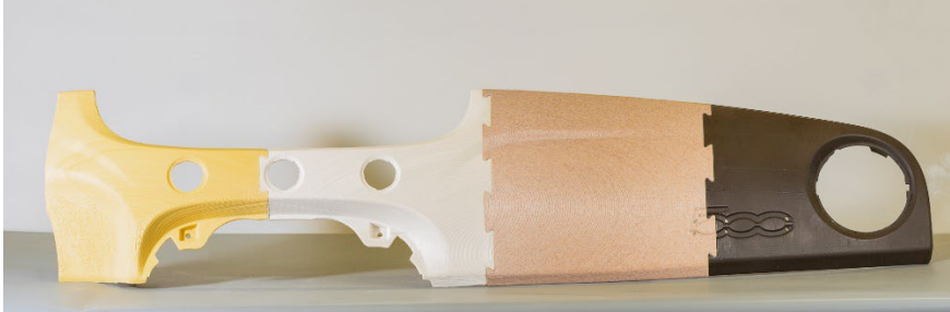
Figura 1 – Salpicadero de automóvil con colores diferentes colores, aromas y acabados con capacidades antimicrobiales
